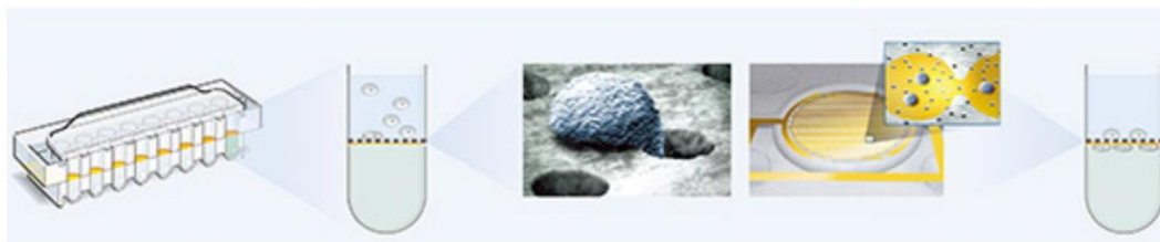
Fig 36. Principiul tehnologiei xCELLigence pentru experimentele de migrare celulara. Cellulele atrase de factorii existenți în compartimentul inferior, patrund prin porii din peretele inferior al compartimentului superior. Instrumentul RTCA DP indexul celular al celulelor care trec dintr-un compartiment în celalalt. http://www.aceabio.com/theory.aspx?cateid=398
