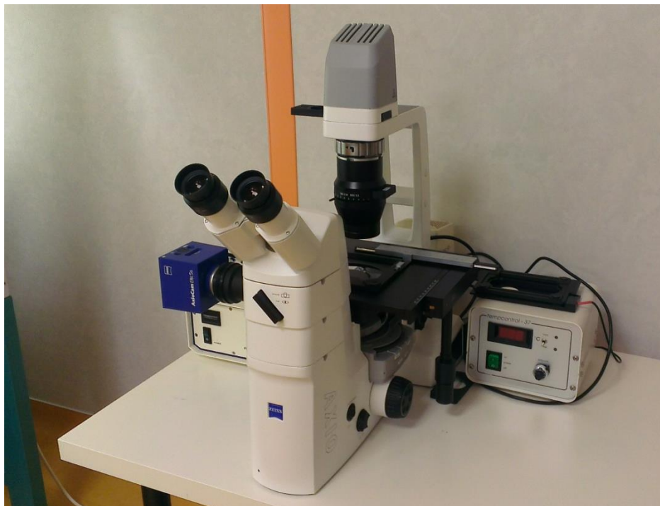
Fig.18. Microscopul Axiovert A1 Zeiss cu filtrele de fluorescenta si sistemul de achizitie de imagini
