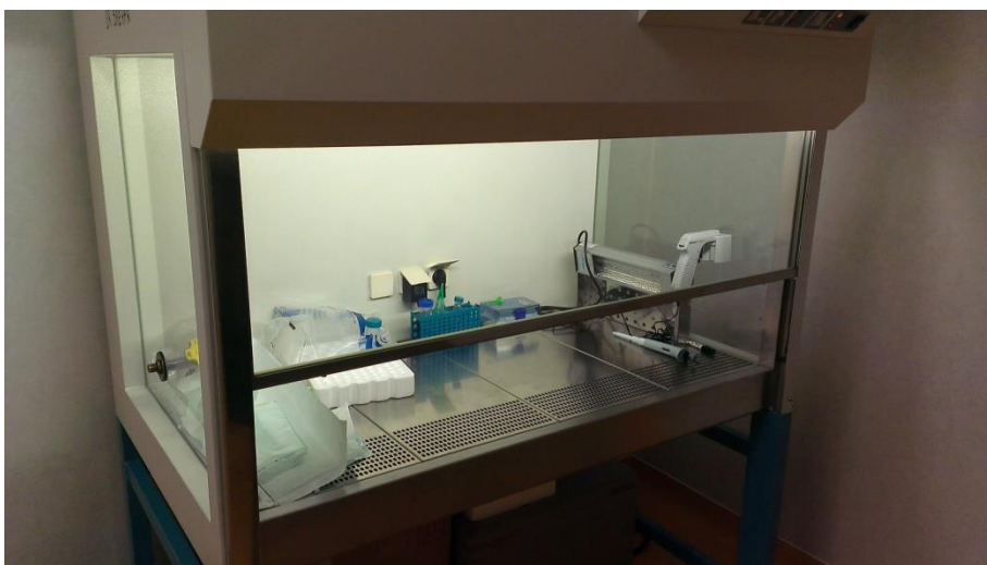
Fig.10. Hota cu flux laminar utilizata in experimente
